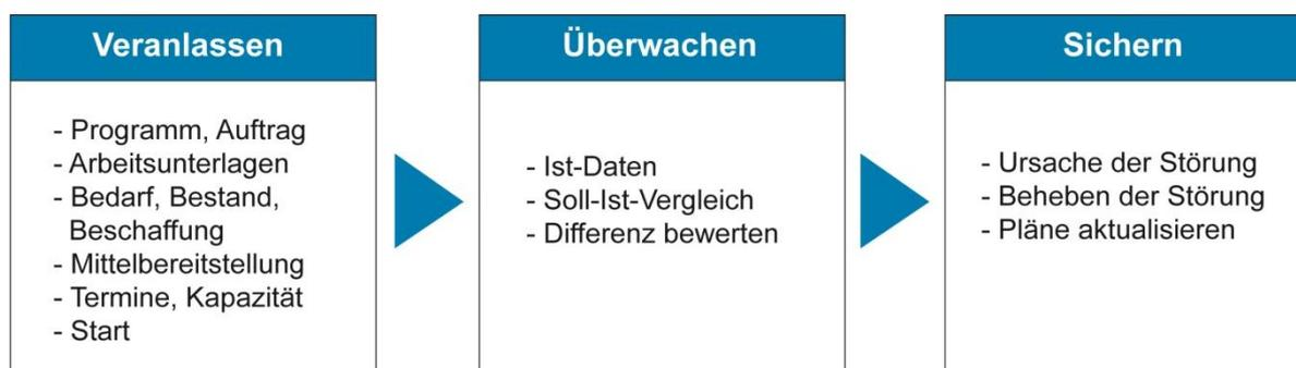
Abbildung 07: Zusammenfassung Bauüberwachung<sup>177</sup>
